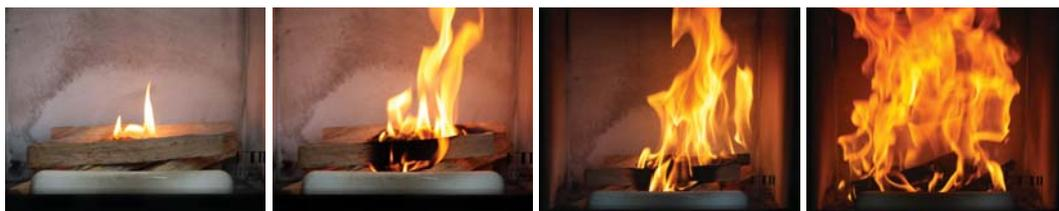
Il metodo di accensione dall'alto si applica principalmente a **stufe a legna, stufe ad accumulo, camini ad inserto**. Il fumo è un primo indicatore della produzione del particolato.
